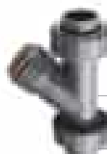
CLAPET DE RETENUE PVC PN 16. Union 3 pièces femelles taraudées pas du gaz - Joint EPDM REF. VRUFV
