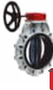
VANNE PAILLON PVC CORPS EN PP GR PN 10. Manchette EPDM ou FPM Commande manuelle par réducteur REF. FKOV/CR
