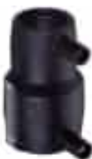
MR - MANCHON DE RÉDUCTION ÉLECTROSOUDABLE PE 100 SDR 11 (Eau 16 bar, Gaz 10 bar) Pour tubes SDR 11 à 17.6
