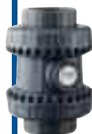
CLAPET DE RETENUE A BOULE PVC EASYFIT PN 16. Femelles à coller Joints EPDM ou FPM. Contre pression minimale : 0,2 bar. REF. SXEIV
