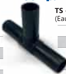
T - TÉ ÉLECTROSOUDABLE PE 100 SDR 11 (Eau 16 bar, Gaz 10 bar)
