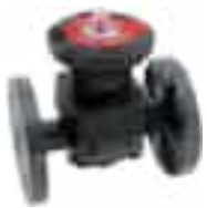
VANNE PVC A MEMBRANE Avec brides fixes suivant EN/ISO/DIN. DIN 8063 PN 10/16. Encombrement suivant DIN 3202 PN 10. Joints EPDM, FPM ou EPDM/PTFE REF. DKOV
