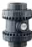
CLAPET DE RETENUE A BOULE PVC EASYFIT avec ressort en inox 316 revêtu PTFE PN 16. Femelles à coller Joints EPDM ou FPM REF. SSEIV
