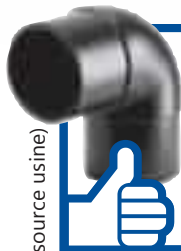
WS90° - COUDE LISSE À 90° PE 100 SDR 11 (Eau 16 bar, Gaz 10 bar) + 2 manchons
