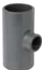
TE RÉDUIT 90° PVC PRESSION PN 16 Femelles à coller REF. TRIV
