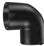
W90° - COUDE ÉLECTROSOUDABLE À 90° PE 100 SDR 11 (Eau 16 bar, Gaz 10 bar)
