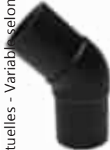
WS45° - COUDE LISSE À 45° PE 100 SDR 11 (Eau 16 bar, Gaz 10 bar) + 2 manchons
